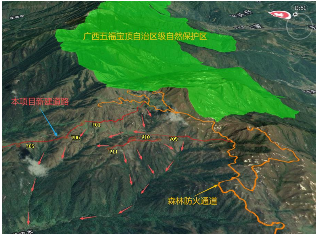
图 4-1 本项目施工汇水与自然保护位置关系图（红色箭头为汇水方向）
